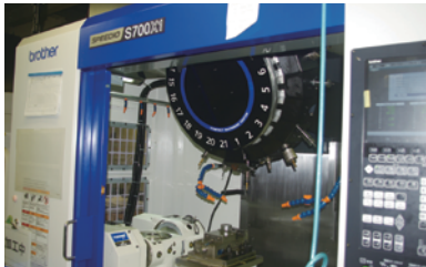
スパーバG1チャックをセットした新設備はインテックテーブルもユキワ精工製
